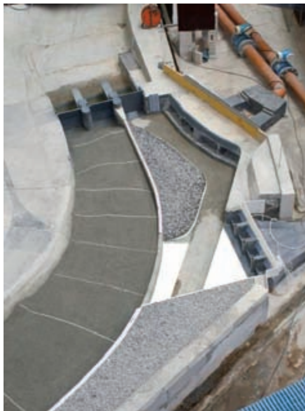
Modèle physique du barrage de Lavey avec la nouvelle prise d'eau du projet Lavey+
