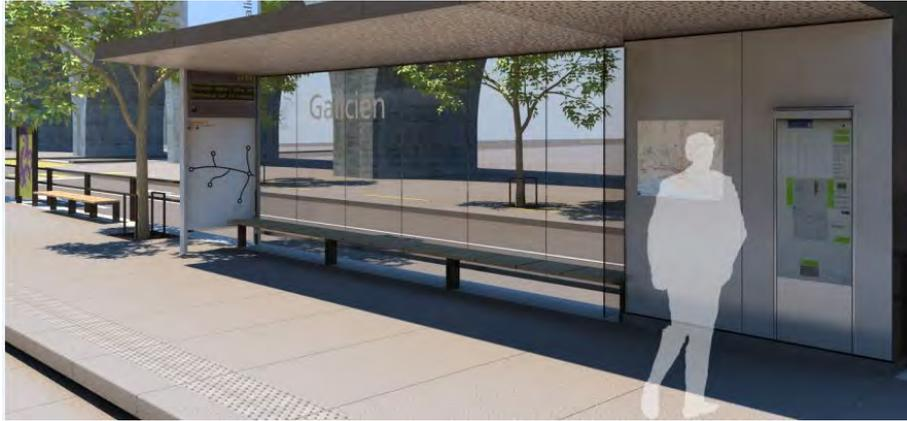
La géométrie des quais respecte non seulement les standards de sécurité, mais prend également en compte les besoins des utilisateurs à mobilité réduite et des malvoyants. En effet, rehaussés de 30 centimètres par rapport à la chaussée, leur configuration permettra une entrée facilitée (à niveau) dans les rames du tramway et la pente des rampes d'extrémités n'excédera pas 6%. Enfin, des bandes tactilo-visuelles seront disposées le long des quais à l'intention des personnes malvoyantes.
