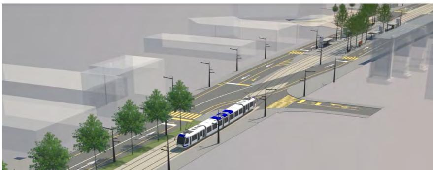
*Bascule entre le positionnement latéral et central du tramway dans le secteur du Galicien*
