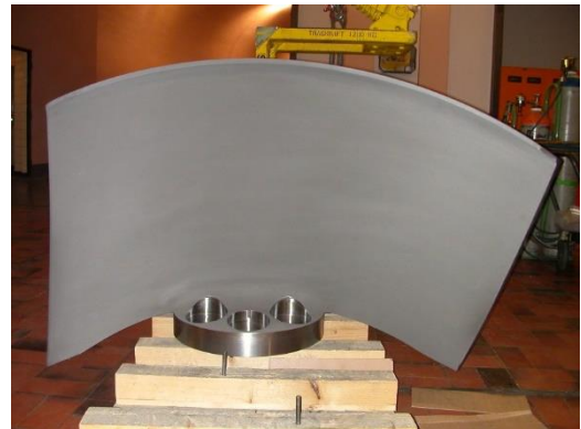
Pale réparée avec la protection anti-usure
